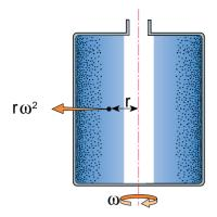
Fig. 6.2.14 A simple separator
