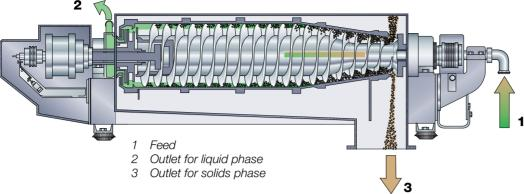
Fig. 15.8 Decanter centrifuge.
